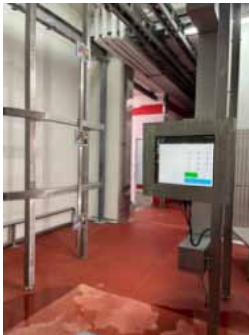
Fot. 3. Zatwierdzone urządzenie do automatycznej klasyfikacji tusz wołowych EstiBeef 6 (źródło: IJHARS)
